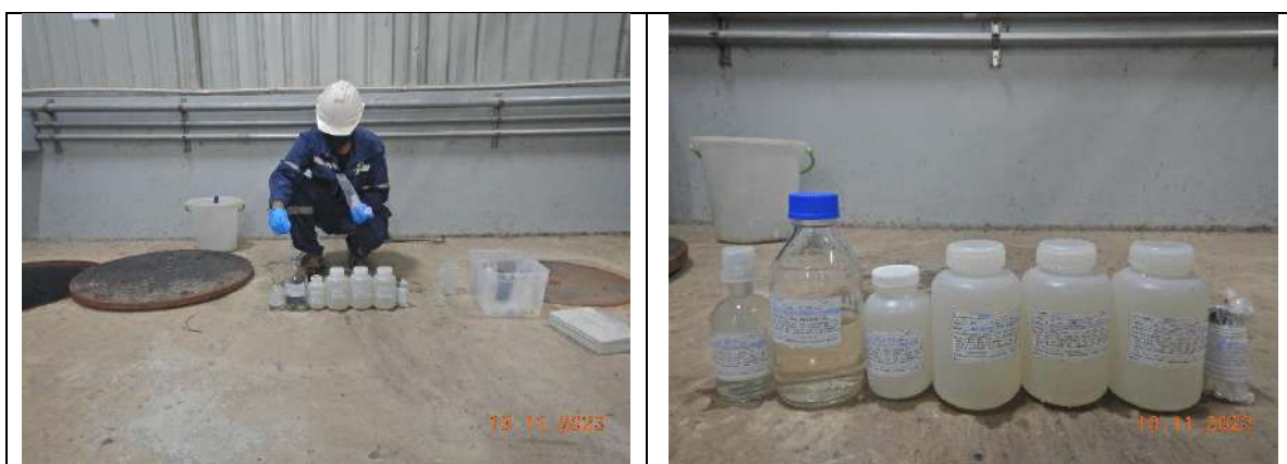
รูปที่ 3.2.1-4 ภาพถ่ายการเก็บตัวอย่างน้ำทิ้งภายหลังการบำบัดของระบบบำบัดน้ำเสีย ชุดที่ 2 ระหว่างเดือนกรกฎาคม-ธันวาคม 2566 (ระยะดำเนินการ)
